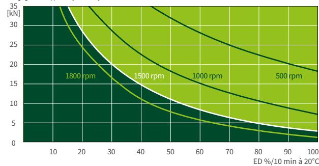
Ce diagramme donne une orientation dans des conditions industrielles standard (temp. ambiante 20°C, etc.) et avec un entretien correct (lubrification, etc.). Les diagrammes sont basés sur le filetage trapézoïdal standard Tr 40x7 de ZIMM. Avec la vis à billes KGT, la durée d'utilisation peut être bien plus longue.
