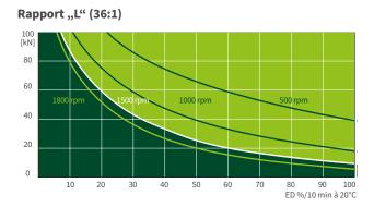
Ce diagramme donne une orientation dans des conditions industrielles standard (temp. ambiante 20°C, etc.) et avec un entretien correct (lubrification, etc.). Les diagrammes sont basés sur le filetage trapézoïdal standard Tr 55x9 de ZIMM. Avec la vis à billes KGT, la durée d'utilisation peut être bien plus longue.
