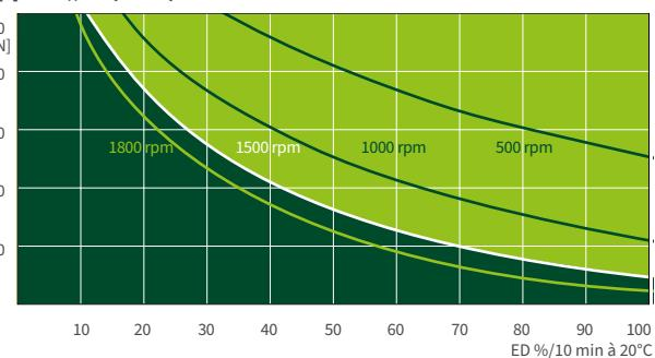
Ce diagramme donne une orientation dans des conditions industrielles standard (temp. ambiante 20°C, etc.) et avec un entretien correct (lubrification, etc.). Les diagrammes sont basés sur le filetage trapézoïdal standard Tr 40x7 de ZIMM. Avec la vis à billes KGT, la durée d'utilisation peut être bien plus longue.
