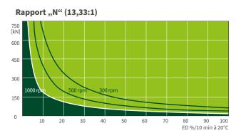
Ce diagramme donne une orientation dans des conditions industrielles standard (temp. ambiante 20°C, etc.) et avec un entretien correct (lubrification, etc.). Les diagrammes sont basés sur le filetage trapézoïdal standard Tr 140x20 de ZIMM. Avec la vis à billes KGT, la durée d'utilisation peut être bien plus longue.
