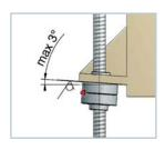
Une autre possibilité de compenser les défauts de géométrie est d'utiliser nos alésages pivotants intégrés dans le vérin ou le supportcardan KAR (voir chapitre 4).
