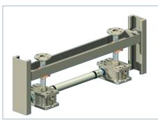
Veiller au parallélisme et à la perpendicularité des surfaces de fixation, vérins, écrous et guidages les uns par rapport aux autres. De même qu'à l'alignement des vérins, paliers de maintien, arbres de transmission et moteurs. Nous recommandons d'effectuer le redressage à l'aide d'un niveau à bulle de précision pour machine.
