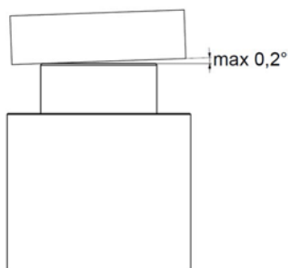
Figure 1 : la charge est posée sans être fixée.
