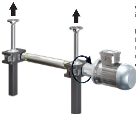
Bien vérifier les sens de rotation et de déplacement des différents composants et les dessiner sur votre plan ou choisir l'une de nos configurations standard (liste de contrôle). Pour les renvois d'angle en T, le sens de rotation peut être inversé par retournement du carter.
