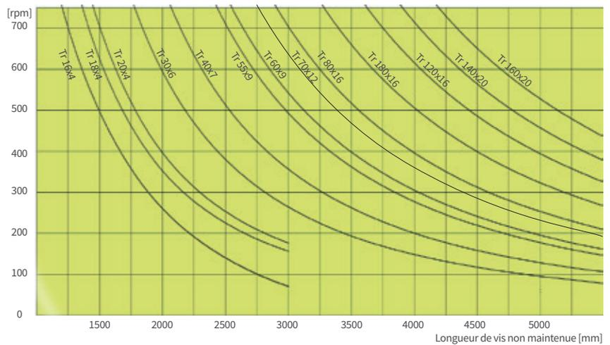
Pour les vérins R (à vis tournante) à vis longue et de petit diamètre, il est nécessaire de déterminer la vitesse maximum admissible de la vis. Pour cela, relever la vitesse critique théorique  $n_{cr}$  correspondante dans le diagramme ci-dessus. Pour déterminer la longueur de vis non maintenue, tenir également compte de la longueur du soufflet, etc. La formule ci-dessus et le facteur de correction permettent de calculer la vitesse maximum admissible de la vis.
