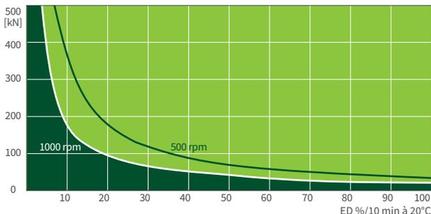
Ce diagramme donne une orientation dans des conditions industrielles standard (temp. ambiante 20°C, etc.) et avec un entretien correct (lubrification, etc.). Les diagrammes sont basés sur le filetage trapézoïdal standard Tr 120x16 de ZIMM. Avec la vis à billes KGT, la durée d'utilisation peut être bien plus longue.
