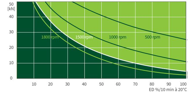
Ce diagramme donne une orientation dans des conditions industrielles standard (temp. ambiante 20°C, etc.) et avec un entretien correct (lubrification, etc.).
