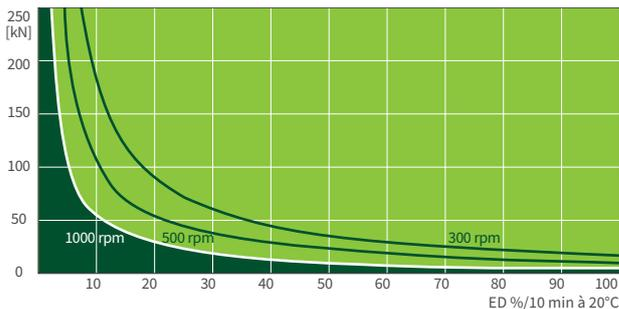
Ce diagramme donne une orientation dans des conditions industrielles standard (temp. ambiante 20°C, etc.) et avec un entretien correct (lubrification, etc.). Les diagrammes sont basés sur le filetage trapézoïdal standard Tr 160x20 de ZIMM. Avec la vis à billes KGT, la durée d'utilisation peut être bien plus longue.
