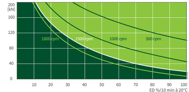
Ce diagramme donne une orientation dans des conditions industrielles standard (temp. ambiante 20°C, etc.) et avec un entretien correct (lubrification, etc.). Les diagrammes sont basés sur le filetage trapézoïdal standard Tr 70x12 de ZIMM. Avec la vis à billes KGT, la durée d'utilisation peut être bien plus longue. Si vous avez besoin d'un cycle de service ou de performance encore plus élevé, vous trouverez des informations sur nos réducteurs haute performance ZE-H la page 70 et 71.
