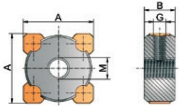
Un système anti-rotation est nécessaire si la vis n'est pas liée à la construction de manière à ne pas pouvoir tourner ou en liaison avec un interrupteur de fin de course ou une tête sphérique KGK.
