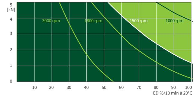
Ce diagramme donne une orientation dans des conditions industrielles standard (temp. ambiante 20°C, etc.) et avec un entretien correct (lubrification, etc.). Les diagrammes sont basés sur le filetage trapézoïdal standard Tr 18x4 de ZIMM. Avec la vis à billes KGT, la durée d'utilisation peut être bien plus longue.
