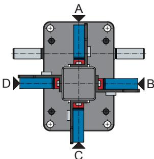
Les fins de course peuvent être montés sur les 4 faces du tube de protection.
