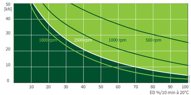
Ce diagramme donne une orientation dans des conditions industrielles standard (temp. ambiante 20°C, etc.) et avec un entretien correct (lubrification, etc.). Les diagrammes sont basés sur le filetage trapézoïdal standard Tr 40x7 de ZIMM. Avec la vis à billes KGT, la durée d'utilisation peut être bien plus longue.
