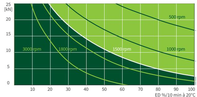
Ce diagramme donne une orientation dans des conditions industrielles standard (temp. ambiante 20°C, etc.) et avec un entretien correct (lubrification, etc.). Les diagrammes sont basés sur le filetage trapézoïdal standard Tr 30x6 de ZIMM. Avec la vis à billes KGT, la durée d'utilisation peut être bien plus longue.
