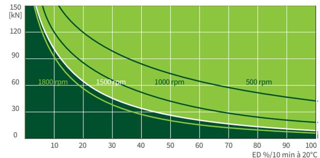
Ce diagramme donne une orientation dans des conditions industrielles standard (temp. ambiante 20°C, etc.) et avec un entretien correct (lubrification, etc.). Les diagrammes sont basés sur le filetage trapézoïdal standard Tr 60x9 de ZIMM. Avec la vis à billes KGT, la durée d'utilisation peut être bien plus longue.
