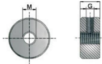
La sécurité anti-sortie empêche la sortie de la vis du vérin. Particulièrement recommandée pour les vis d'entraînement à billes. Ne pas utiliser en tant que butée de fonctionnement !
