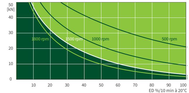
Ce diagramme donne une orientation dans des conditions industrielles standard (temp. ambiante 20°C, etc.) et avec un entretien correct (lubrification, etc.). Les diagrammes sont basés sur le filetage trapézoïdal standard Tr 50x8 de ZIMM. Avec la vis à billes KGT, la durée d'utilisation peut être bien plus longue.
