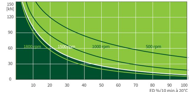
Ce diagramme donne une orientation dans des conditions industrielles standard (temp. ambiante 20°C, etc.) et avec un entretien correct (lubrification, etc.). Les diagrammes sont basés sur le filetage trapézoïdal standard Tr 60x9 de ZIMM. Avec la vis à billes KGT, la durée d'utilisation peut être bien plus longue. Si vous avez besoin d'un cycle de service ou de performance encore plus élevé, vous trouverez des informations sur nos réducteurs haute performance ZE-H la page 70 et 71.
