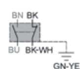
Pour les applications de sécurité, utiliser uniquement le contact de rupture !
