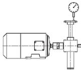
La **précision du pas de la vis** à filetage trapézoïdal est de 0,2 mm mesurée sur une longueur filetée de 300 mm ; pour les vis à billes, elle est de 0,05 mm sur une longueur filetée de 300 mm.
