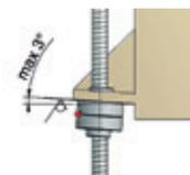
Une autre possibilité de compenser les défauts de géométrie est d'utiliser nos alésages pivotants intégrés dans le vérin ou le supportcardan KAR (voir chapitre 3).
