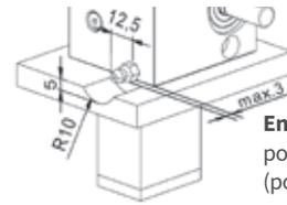
**Encombrement minimum** pour lubrification de la vis (pompe à graisse)
