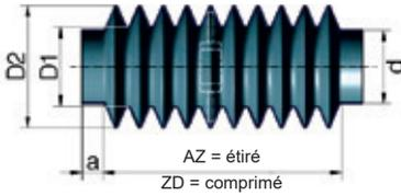
Matériau : Tissu en polyester enduit de PU, résistance thermique -18°C à +70°C, résistant UV, bon comportement à l'humidité avec bagues pour les utilisations horizontales, Pour des courses à partir de 1000 mm avec protection anti-sortie, avec 2 bagues de serrage
