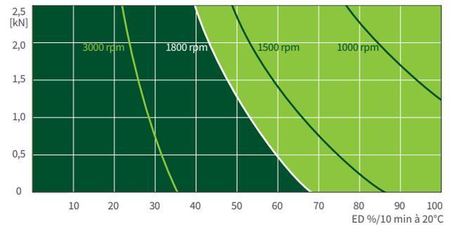
Ce diagramme donne une orientation dans des conditions industrielles standard (temp. ambiante 20°C, etc.) et avec un entretien correct (lubrification, etc.). Les diagrammes sont basés sur le filetage trapézoïdal standard Tr 16x4 de ZIMM. Avec la vis à billes KGT, la durée d'utilisation peut être bien plus longue.
