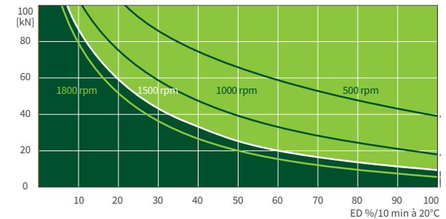
Ce diagramme donne une orientation dans des conditions industrielles standard (temp. ambiante 20°C, etc.) et avec un entretien correct (lubrification, etc.). Les diagrammes sont basés sur le filetage trapézoïdal standard Tr 55x9 de ZIMM. Avec la vis à billes KGT, la durée d'utilisation peut être bien plus longue.
