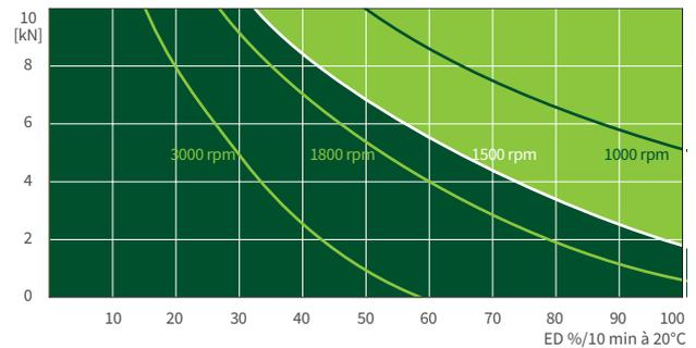
Ce diagramme donne une orientation dans des conditions industrielles standard (temp. ambiante 20°C, etc.) et avec un entretien correct (lubrification, etc.). Les diagrammes sont basés sur le filetage trapézoïdal standard Tr 20x4 de ZIMM. Avec la vis à billes KGT, la durée d'utilisation peut être bien plus longue.
