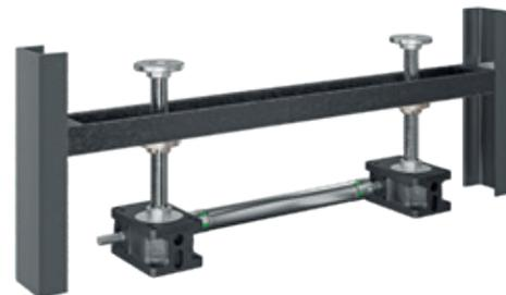
Veiller au parallélisme et à la perpendicularité des surfaces de fixation, vérins, écrous et guidages les uns par rapport aux autres. De même qu'à l'alignement des vérins, paliers de maintien, arbres de transmission et moteurs. Nous recommandons de procéder à l'alignement à l'aide d'un niveau à bulle de précision.
